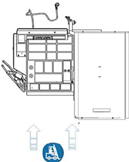
Транспортировка и перемещение станка должны выполняться в направлении, указанном на рисунке.
